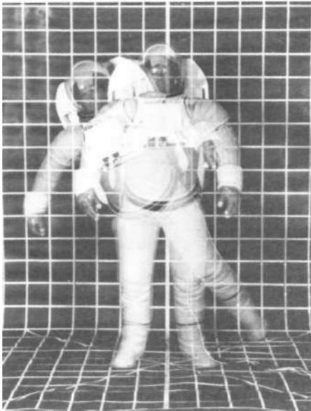
Fig. 2-9. Envoltura espacial definida por el movimiento corporal al realizar una actividad simple. Fotografía cortesía de la National Aeronautics and Space Administration.
