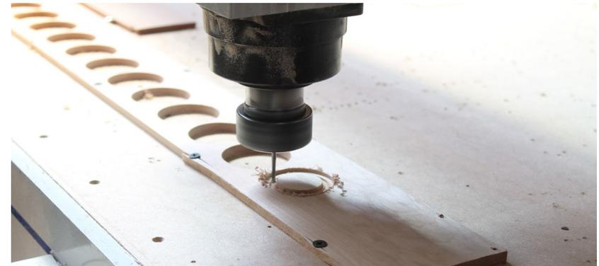
Imagen 102: Fotos de elaboración propia. CNC fabricando anillos de madera.
