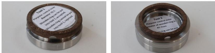
Imágenes 108-109: De elaboración propia. Tester 1 para probar el diámetro interior que tiene contacto con el cristal y tester 2 que prueba el diámetro exterior de la "pestaña" para el encaje de la piezas en el cuerpo del reloj.
