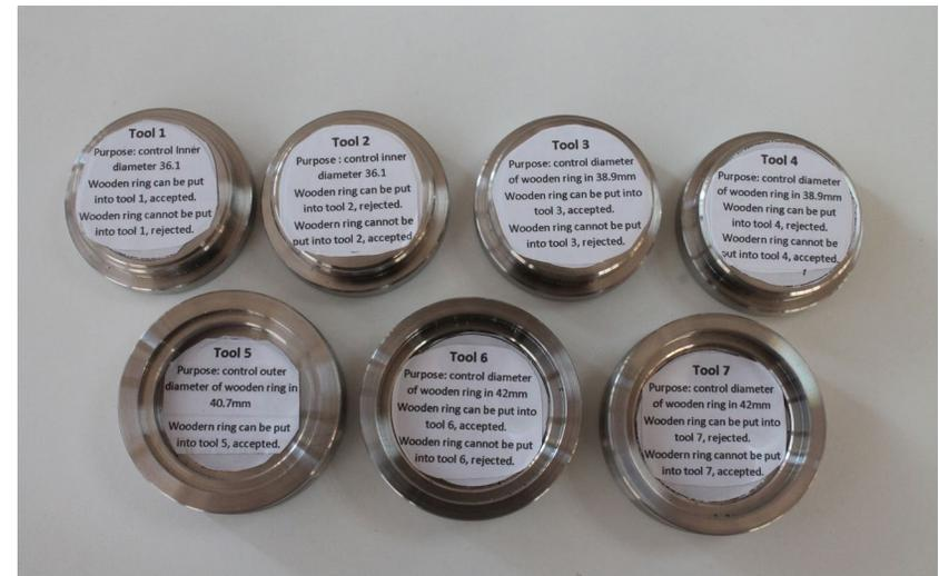
Imagen 106: De elaboración propia. Testers para los prueba de los anillos de madera.
