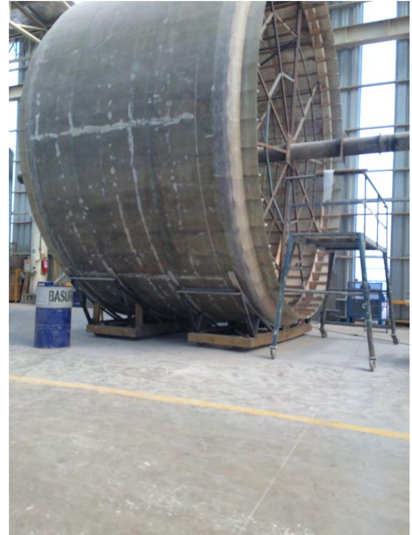
Imagen 15: Maquina de Filament Winding en instalaciones de Exfibro. Fuente: Autoria propia.
