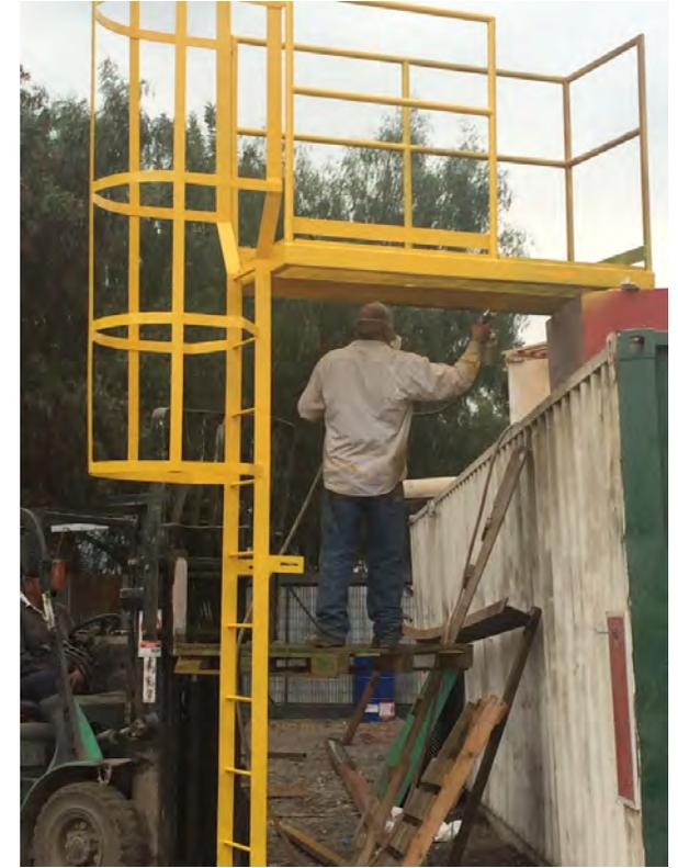
Imagen x-X: Proceso de fabricación escalera-plataforma ECOVA. Fuente: Autoría propia.
