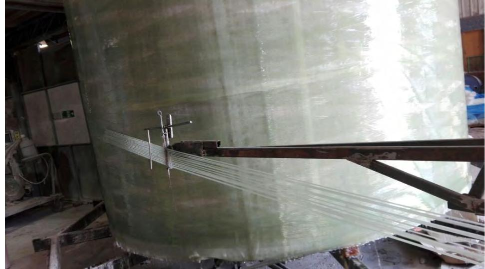
Imagen 29: Proceso de fabricación de mantos, Filament Winding. Fuente: Autoría propia.
