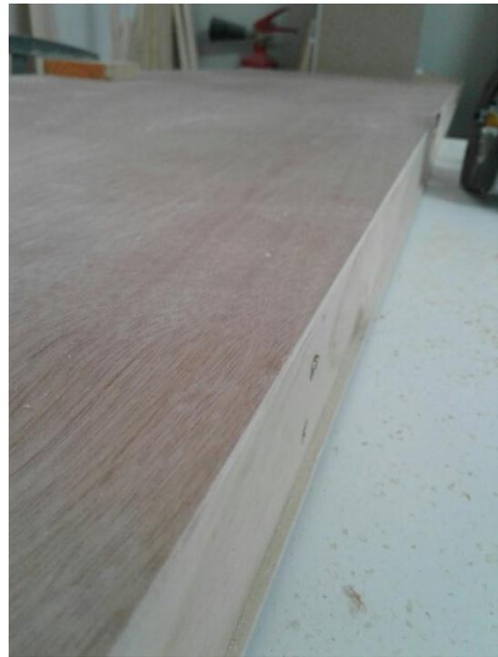
*Figura 55: Detalle rectificación bordes puertas. Elaboración propia.*
