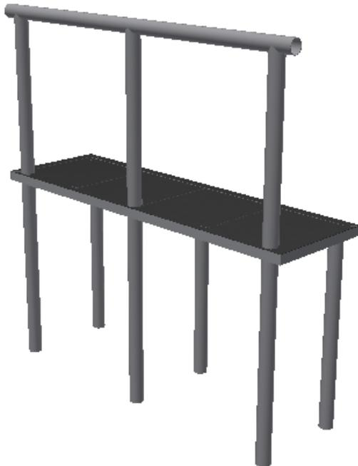
Figura 28: Plataforma de ascenso y descenso. Modelo de elaboración propia.
