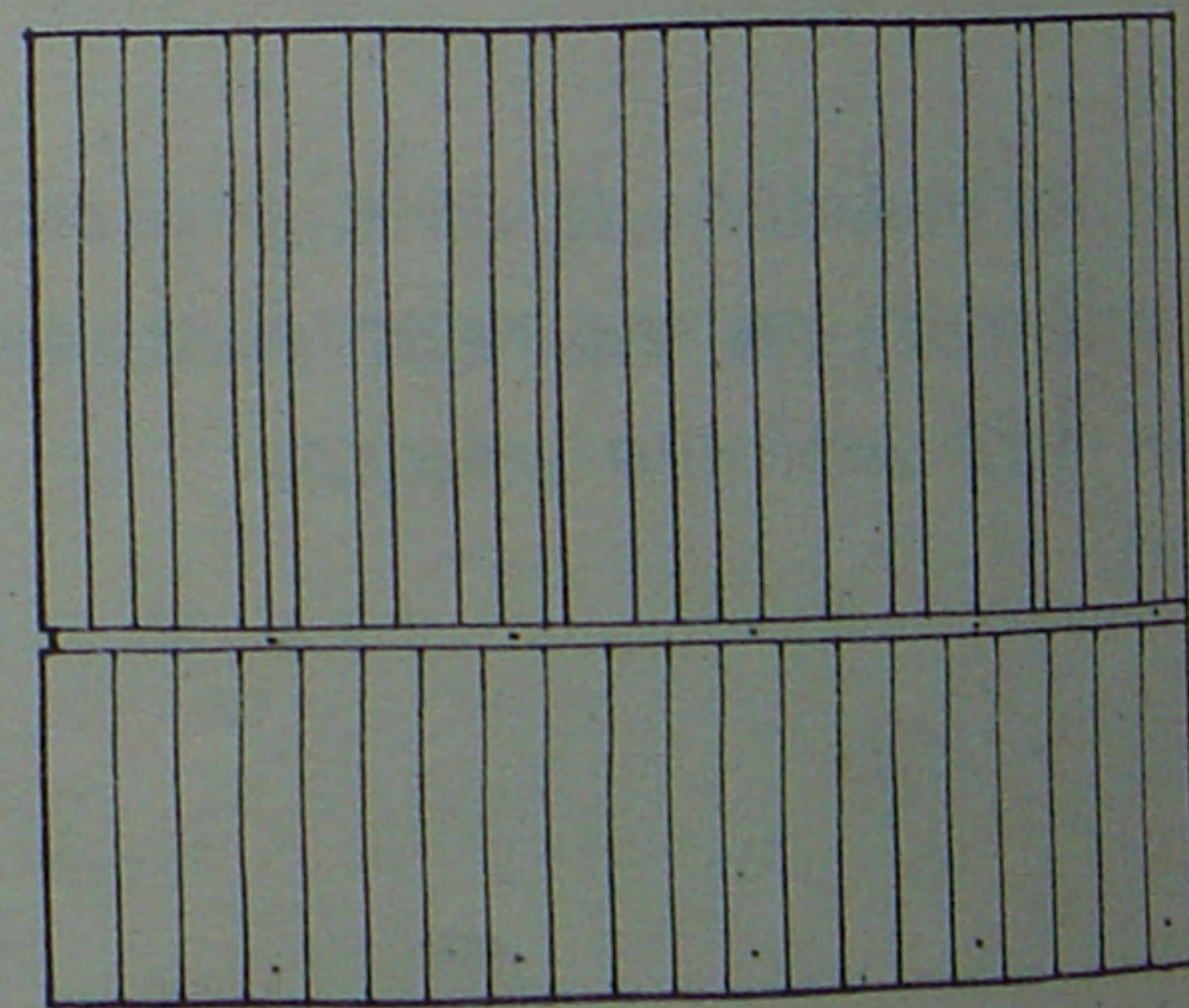
encofrado del hormigón
