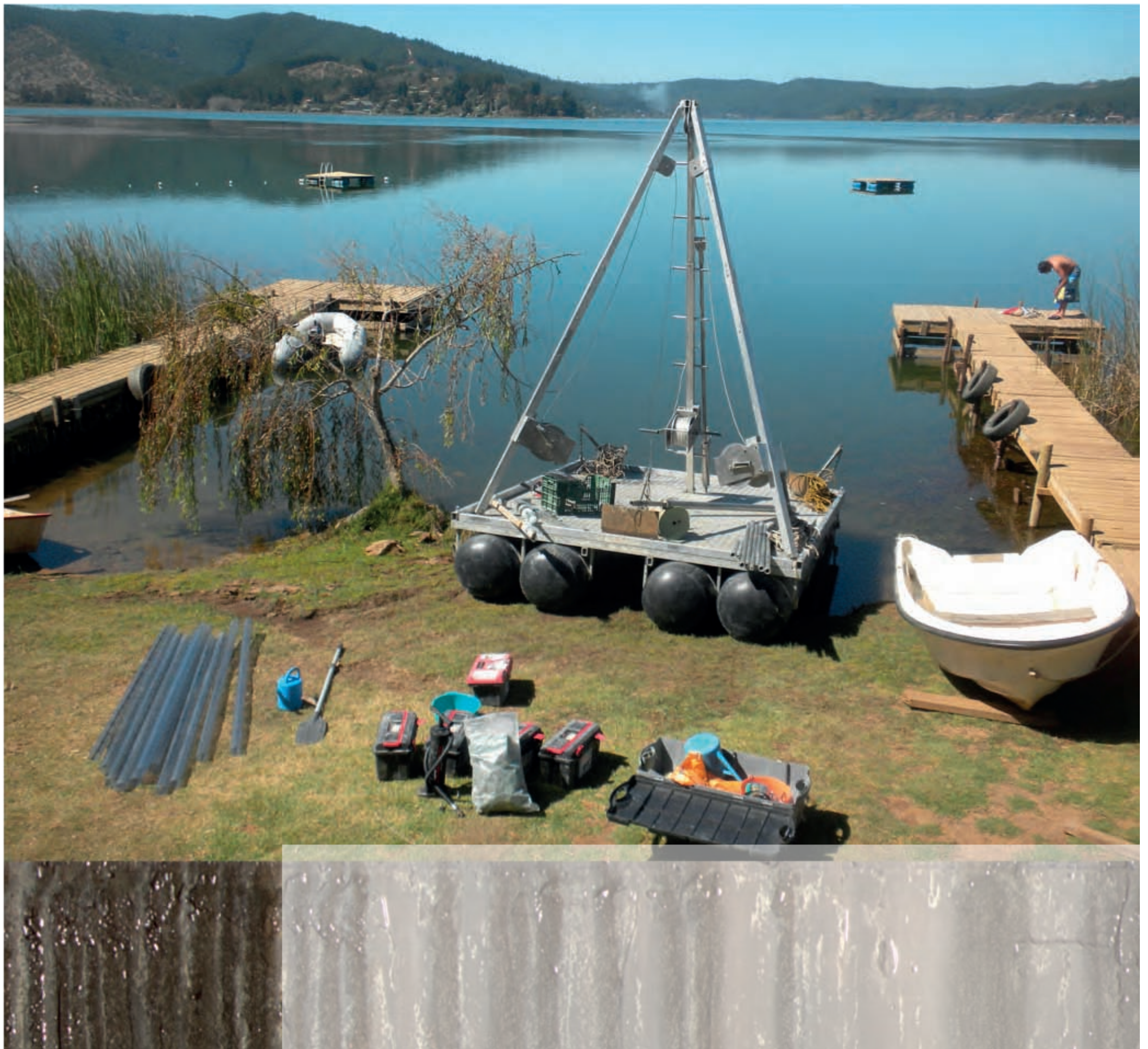
Vista del Lago de Vichuquén con la plataforma tipo Uwitec y el material utilizado para la extracción de los núcleos de sedimentos. En la parte inferior una imagen del sedimento del Lago de Vichuquén. Foto Equipo PaleolPE
