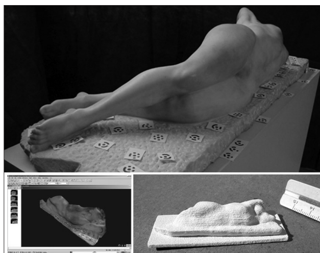
Figura 2. Estudo de caso: fotografiação, processamento e impressão-3D.
