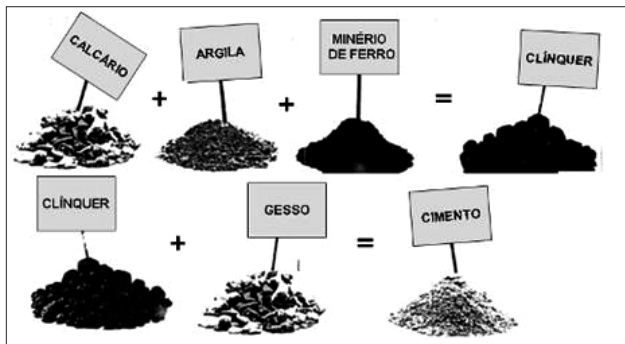
Figura 1. Composição do cimento
