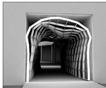
Figura 8: Estrutura de costelas gerada pelo Paracloud.
