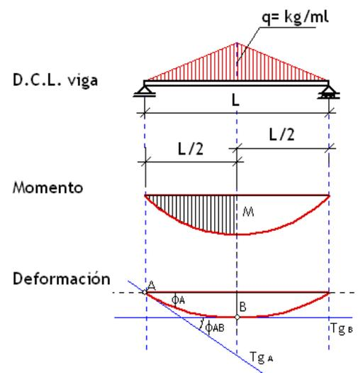
Para determinar la flecha máxima se calcula la desviación tangencial en el extremo de la viga con respecto a la tangente trazada en  $L/2$ .
