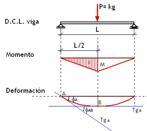
y la flecha máxima la obtenemos calculando la desviación tangencial en el extremo izquierdo con respecto a la tangente trazada por el punto medio de la curva elástica.
