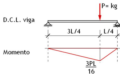
A la viga ficticia le aplicamos como carga el momento flector de la viga dada dividido por  $EI$ . Se determinan los ángulos en los apoyos y el descenso máximo de la viga dada, calculando las reacciones en los apoyos y el momento máximo de la viga ficticia.
