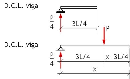
En una viga asimétrica la curva elástica no es simétrica con respecto a su centro, lo que produce una mayor dificultad para determinar el punto cuya tangente sea de pendiente nula. Para determinar los ángulos en los apoyos y la flecha máxima, debemos recordar algunos supuestos iniciales:
