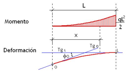
Calculando la desviación tangencial en O (extremo libre de la viga) con respecto a la tangente trazada en el otro extremo, determinamos la flecha máxima.
