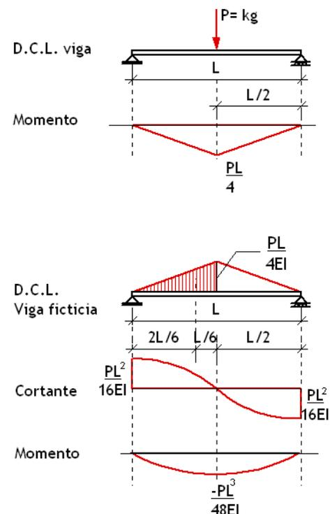
Este valor de ángulo es válido también para el otro extremo, porque la viga es simétrica. Y por la misma condición, el momento máximo se produce cuando  $X=L/2$
