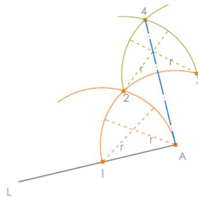
• Con centro en A, trazar un arco de radio  $r$  que corte la semirecta LA determinando el punto 1. Repetir la operación haciendo ahora centro en 1, la intersección de dichos arcos determina el pto. 2.
