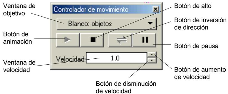
4. Verifique los botones del Controlador de movimiento. En particular, presione los botones de aumento y disminución de velocidad y el botón de inversión de velocidad. Cuando haya terminado, ponga la velocidad en un nivel moderado, 3 o 4.
