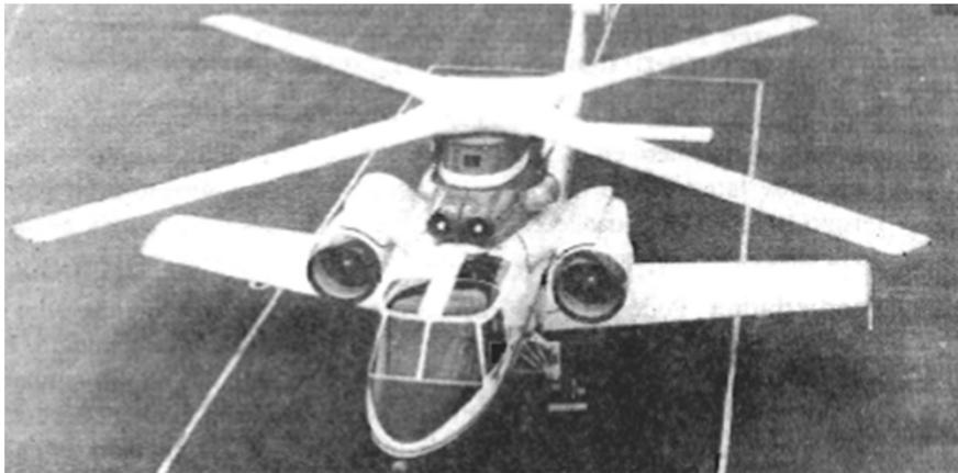
El ala en X de los helicópteros, es de un material compuesto de polímero reforzado con fibra de carbono.
