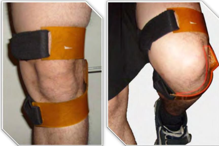
Se fabricaron más modelos con distintas geometrías en un material más flexible (pvc) para identificar las posibilidades estructurales, de posicionamiento, acolchado, amarres y de tamaño, realizándose una prueba en terreno (ascenso y descenso a un cerro por más de cuatro horas).
