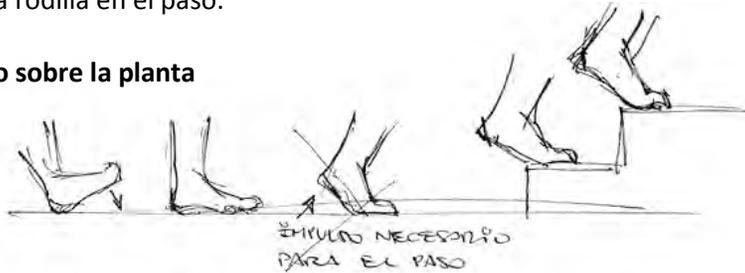
Se experimentó con una maqueta para comprobar la cantidad de rotaciones posibles de lograr con un mecanismo y el peso del cuerpo en un paso como fuerza motriz. El resultado fue favorable, logrando sobre 400 RPM, cumpliendo con los requerimientos de movimiento del generador.
