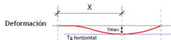
Se determina la flecha cuando  $X = 0.58L$  para obtener la deformación máxima de la viga.
