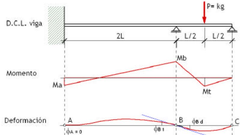
Esta viga a pesar de tener carga solamente en el segundo tramo, la deformación se produce en toda la viga por la condición de continuidad. Las dos incógnitas a resolver son los momentos de empotramiento y de continuidad, para lo cual es imprescindible plantear dos ecuaciones:
