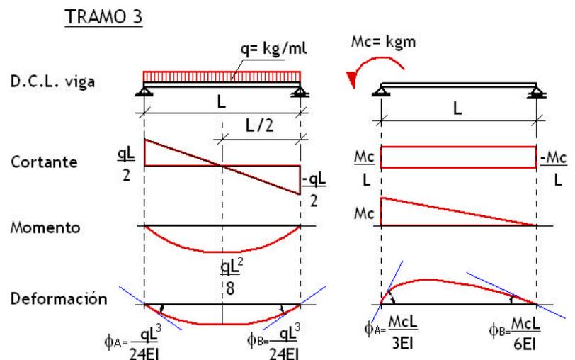
Se igualan los ángulos a ambos lados del apoyo B, por ser opuestos por el vértice; y del mismo modo se procede en el apoyo C
