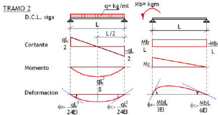
Se iguala los valores de ángulos a ambos lados del apoyo B para determinar el momento de continuidad entre ambos tramos.
