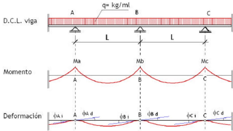
Para deducir el teorema de los tres momentos es necesario considerar que al existir continuidad del elemento estructural se producen momentos flectores en los apoyos intermedios. Cada tramo de viga es afectado por su carga y por los momentos de continuidad que se producen en sus extremos.
