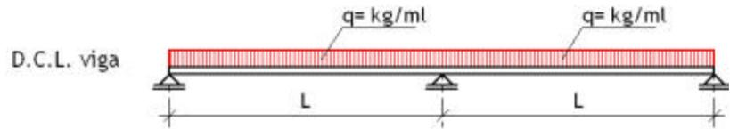
Como la viga es de dos tramos se aplica directamente el teorema de Clapeyrón, reemplazando los valores en la expresión se determina el momento en el apoyo central.
