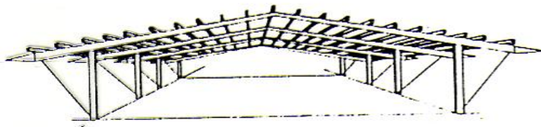
Adaptación de vigas rectas, con tensores metálicos, para conforman un sistema tri-articulado. Luz : 20 a 30 m.
