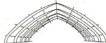
Arco tri-articulado. Luz : 50 a 70 m. Estructura que frecuentemente se usa como silo.
