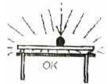
La idea fundamental es producir la **discontinuidad mecánica** entre la fuente productora y la estructura o materialidad susceptible de transmitirla (Incluyendo dentro de este concepto, al terreno mismo). Ella se puede plantear a dos niveles:
