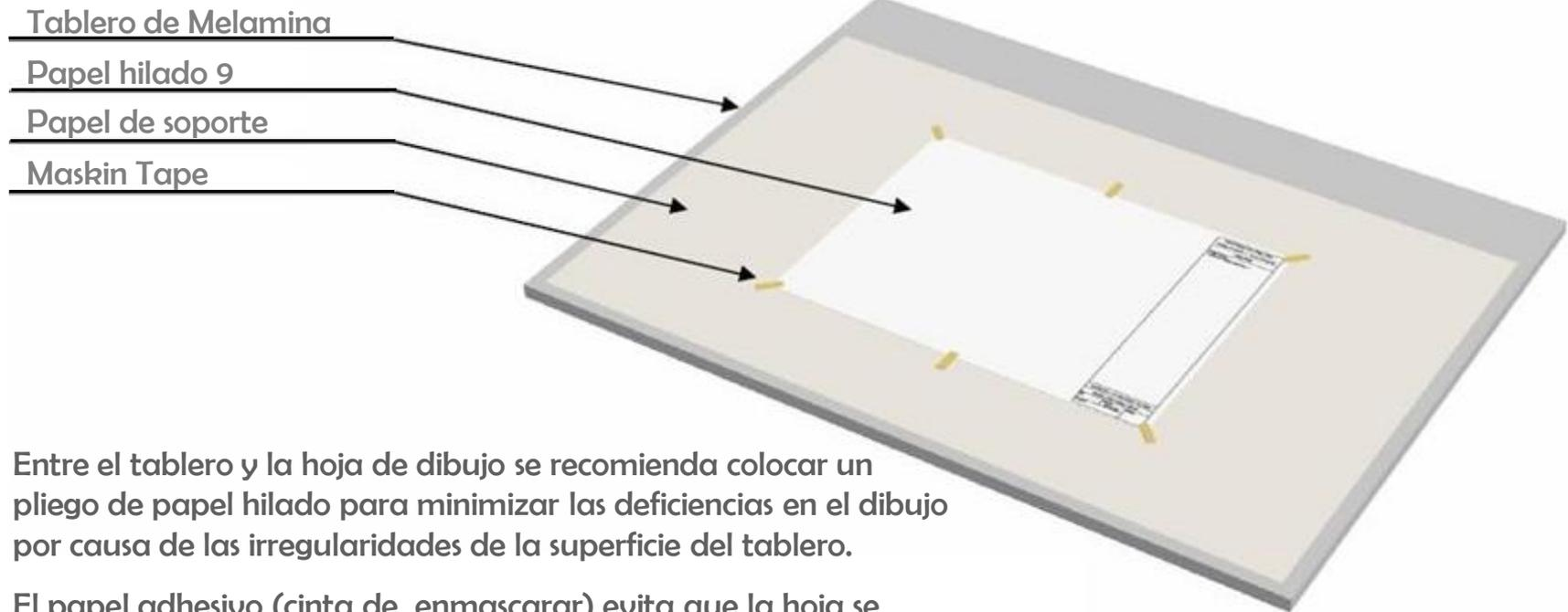
Entre el tablero y la hoja de dibujo se recomienda colocar un pliego de papel hilado para minimizar las deficiencias en el dibujo por causa de las irregularidades de la superficie del tablero.
