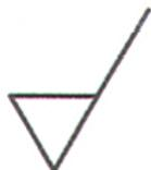
Indicación de que se requiere retirada de material.
