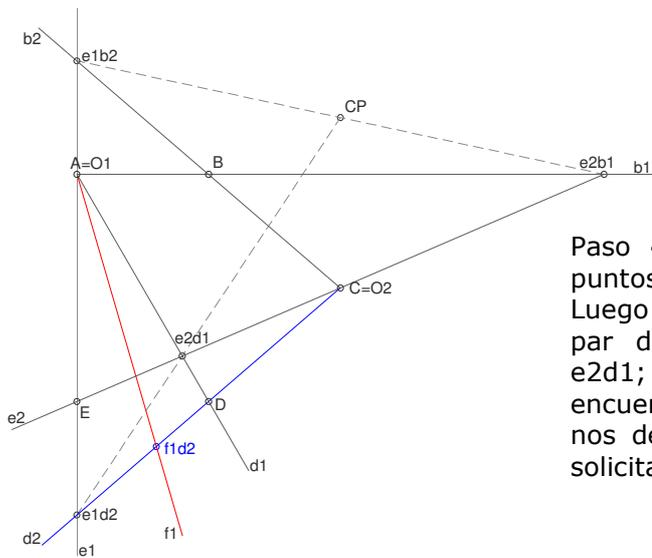
Paso 4. Trazo un segmento que una los puntos correspondientes  $e_{1b2}$  con  $e_{2b1}$ . Luego trazo otro segmento que una el otro par de puntos correspondientes  $e_{1d2}$  con  $e_{2d1}$ ; en la intersección de ambos segmentos encuentro CP, el que al unirse con  $O_1$  y  $O_2$  nos define dos rectas tangentes a la cónica solicitada.
