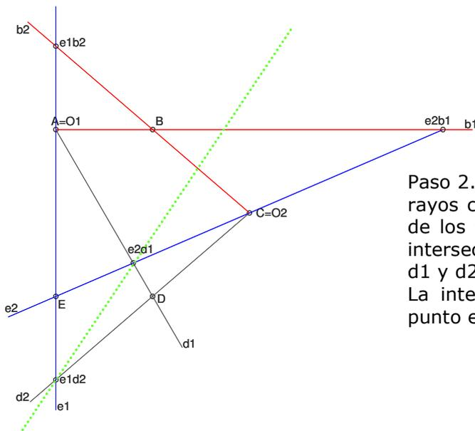
Paso 2. El punto E es la intersección de dos rayos correspondientes e1 y e2 que nacen de los vértices O1 y O2. El punto D es la intersección de dos rayos correspondientes d1 y d2 que nacen de los vértices O1 y O2. La intersección de e1 con d2 generan el punto e1d2, cuyo correspondiente es e2d1.
