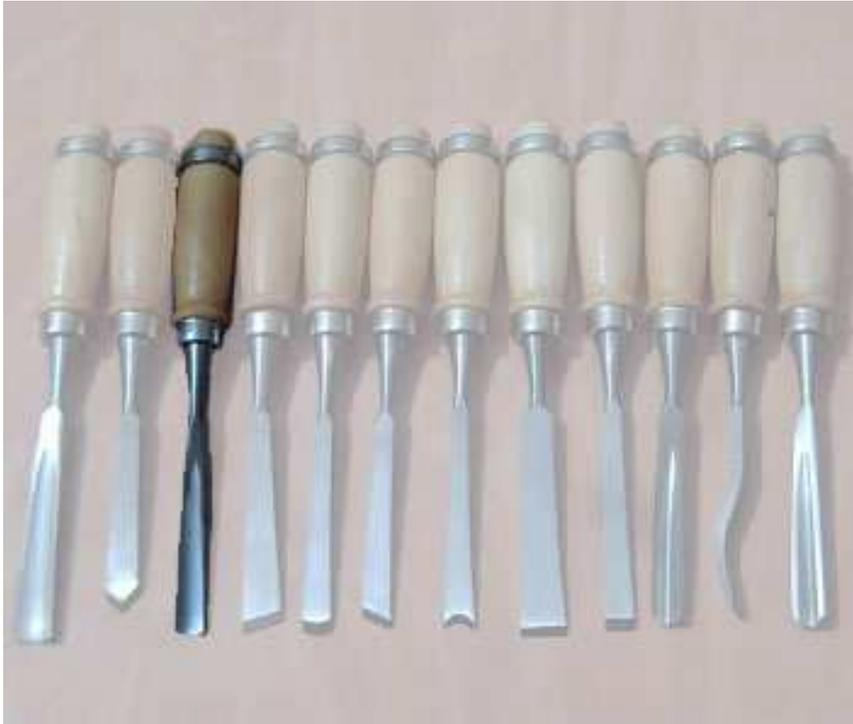
Este instrumento permite ahondar la madera sacando pequeñas porciones de fibra de la madera, la más usada y probablemente la única que utilicen si adquieren un set, corresponde a la gubia de media caña (destacada en la imagen) que permite arrancar curvamente fibras de la madera, siempre a favor de la veta.
