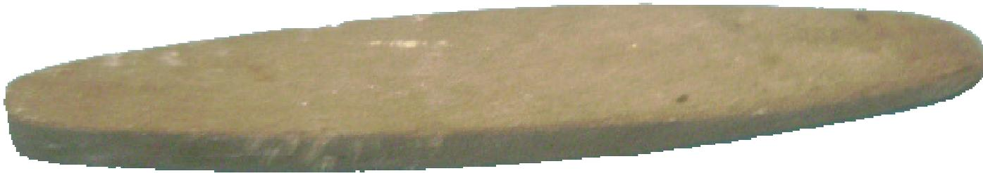
Instrumento que permite pulir y asentar el filo de los instrumentos de corte para desarrollar un correcto trabajo. Se debe utilizar con su superficie húmeda. Se puede adquirir en cualquier ferretería, aunque probablemente exista una en sus casa cuyo fin es afilar los cuchillos de cocina, la cual es útil.
