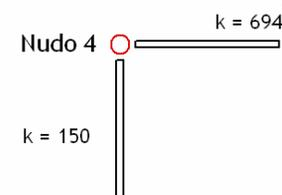
En el nudo 5 la barra 4-5 llega el eje de simetría por lo tanto al considerar un empotramiento el coeficiente de distribución para la barra es:
