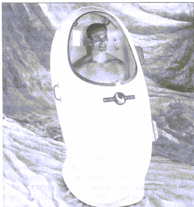
Figura 2-4 El Bod Pod Composition System. El pletismógrafo está construido de fibra de vidrio con una ventana grande de acrílico. Un asiento moldeado separa la unidad en una cámara de prueba (al frente) y una cámara de referencia (atrás) en donde se alojan los instrumentos (véase la figura 2-5).
