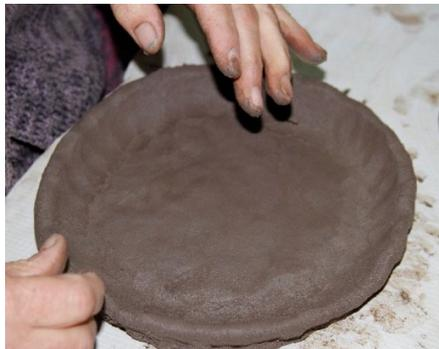
Figura 70: Creación del plato para olla de GG.
