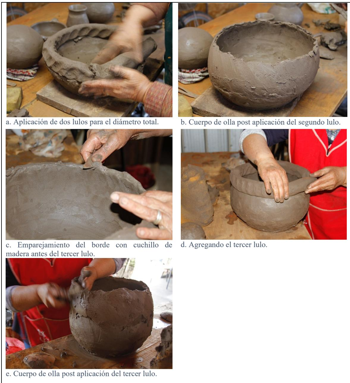
Figura 75: Secuencia operacional de aplicación de lulos para el cuerpo de olla de VG.
