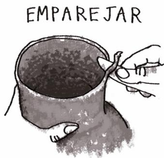
Figura 46: Emparejamiento del labio con el cuchillo de madera.
