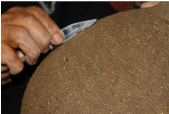
Figura 88: Exposición de antiplásticos al momento de raspar olla de VG.
