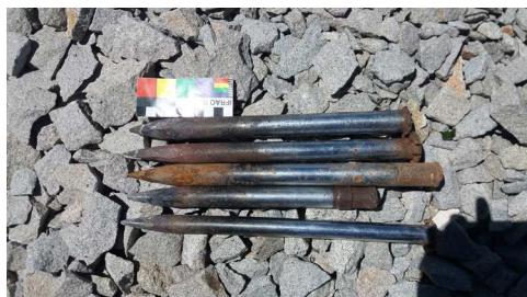
Figura 7. Lakanchira para afinar el ojal y cuñas para partir la pilastra. Fotos: Gabriela Behoteguy, 2018.
