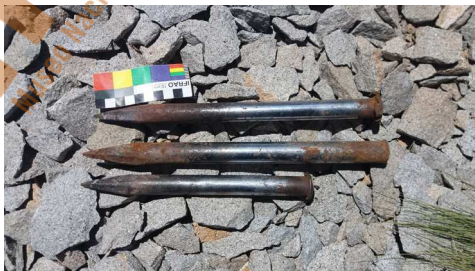
Figura 6. Qalltan punta para comenzar el ojal y mut'u punta para profundizarlo. Fotos: Gabriela Behoteguy, 2018.
