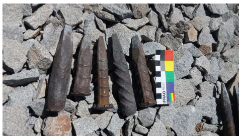
Figura 7. Lakanchira para afinar el ojal y cuñas para partir la pilastra. Fotos: Gabriela Behoteguy, 2018.
