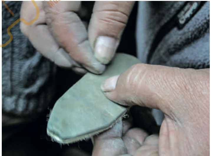
Figura 21. Muestras que fueron hechas por don Gregorio en la cara interna para unir las dos valvas antes del vaciado. Foto: Luisa Vetter.
