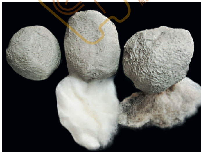
Figura 9. Bolas de masa de arcilla. De izquierda a derecha: arcilla modelada sola, arcilla modelada con algodón, arcilla modelada con fibra de oveja. Foto: Luisa Vetter.
