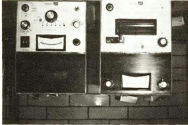
Figura 51. Equipo para medir la termoluminiscencia de los materiales (Instituto de Física de la UNAM, cortesía del doctor Guillermo Espinosa).
