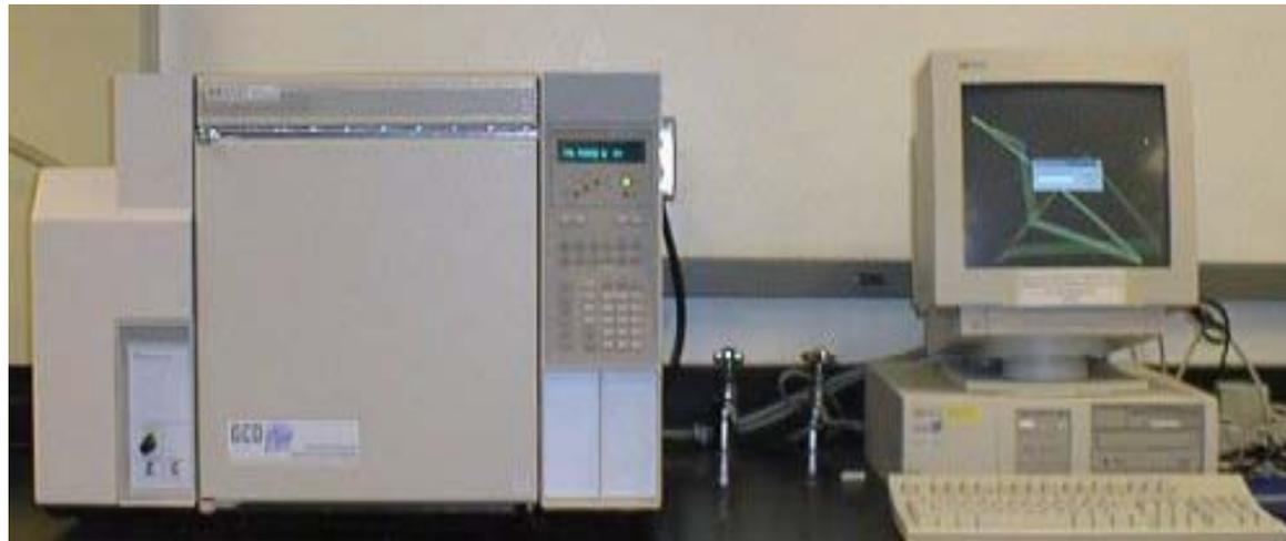
La mezcla de compuestos a analizar es inyectada en el GC, donde es vaporizada.
