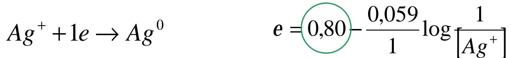
En presencia del halógeno el catión será reducido según la reacción:
