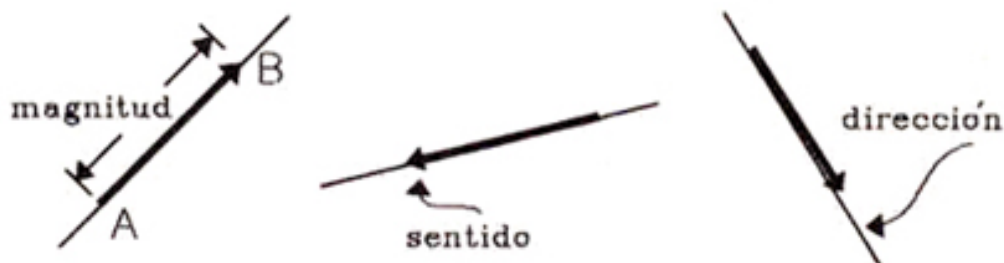
Figura V.2: Representación gráfica de distintos vectores. En cada uno de ellos se indica una de las características de un vector: magnitud , dirección y sentido .
