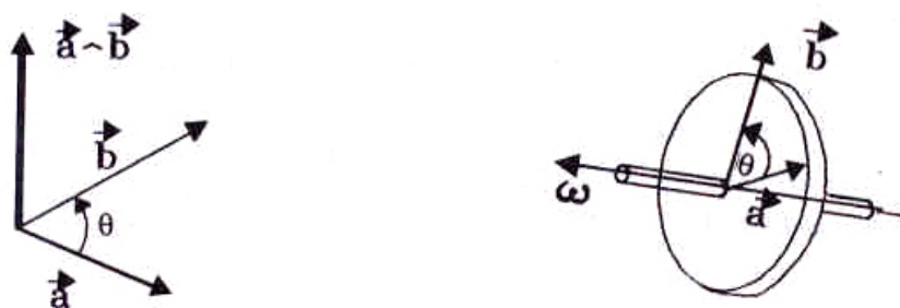
Figura XIII.1: Se indica la dirección y sentido del vector que representa el producto vectorial de los vectores \vec{a} y \vec{b} .
