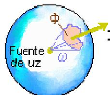
Figura 3: Intensidad Luminosa producida por una fuente de luz
