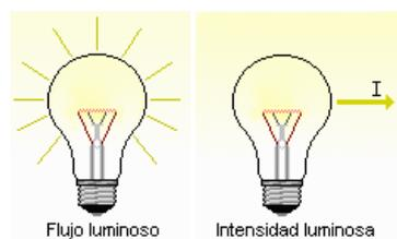
Figura 2: Diferencia entre flujo e intensidad luminosa.
