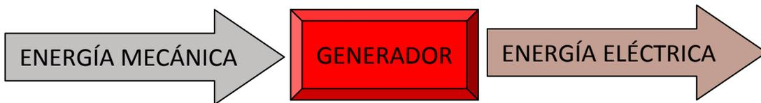
Por otro lado, los generadores son máquinas que al recibir energía mecánica en sus más variadas formas, obtenida a partir de energéticos primarios, permite generar energía eléctrica. Son fundamentales pues la energía eléctrica que nos permite realizar las actividades cotidianas debe ser obtenida de esta forma.
