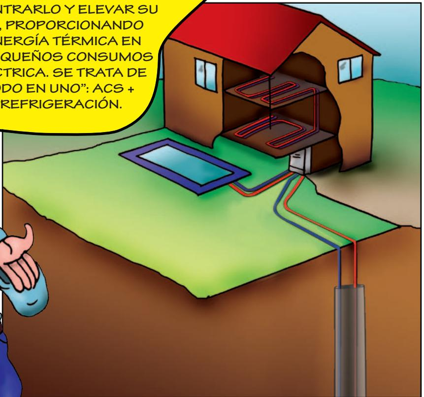
LAS BOMBAS DE CALOR GEOTÉRMICAS TIENEN UN ELEVADO RENDIMIENTO ENERGÉTICO. POR CADA kW DE ENERGÍA ELÉCTRICA QUE CONSUMEN - QUE PUEDE SER DE ORIGEN RENOVABLE- PUEDEN PRODUCIR ENTRE 3 Y 5 kW DE ENERGÍA TÉRMICA PARA CALEFACCIÓN, REFRIGERACIÓN Y PRODUCCIÓN DE AGUA CALIENTE SANITARIA.
