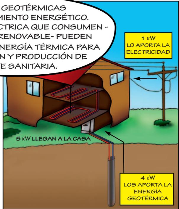
DEPENDE DE SU "COEFICIENTE DE EFICIENCIA ENERGÉTICA", LLAMADO COP, Y ES LA RELACIÓN ENTRE LA ENERGÍA TÉRMICA PRODUCIDA Y LA ENERGÍA ELÉCTRICA CONSUMIDA. DE ESTA FORMA, ENTRE 2 Y 4 kW, QUE PROPORCIONA LA ENERGÍA GEOTÉRMICA SUPERFICIAL, SON GRATIS.
