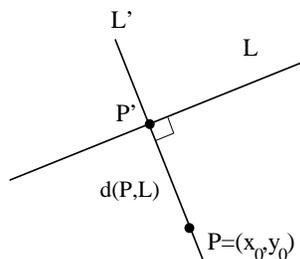
FIGURA 1.17. Cálculo de la distancia de un punto  $P = (x_0, y_0)$  a una recta  $L$ .
