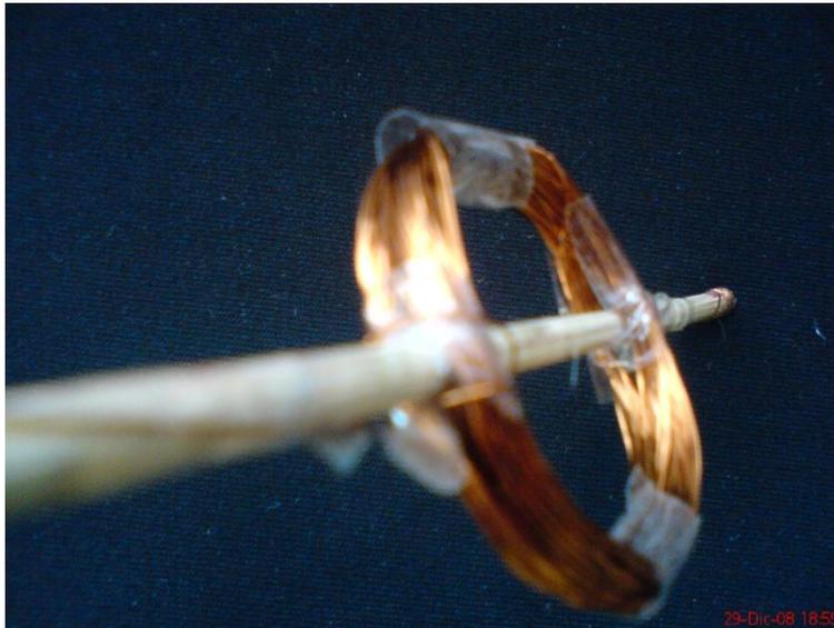
Figura 1: Bobina fija al palo de brocheta.
