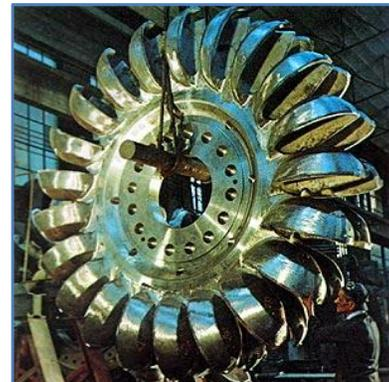
Ilustración 16: Turbina Pelton
