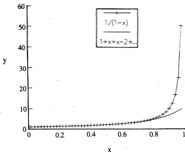
Figura I.2: Comparación entre la función  $1/(1-x)$  ( gráficamente con +) y la aproximación polinomial, que incluye hasta potencias de orden 10 (línea continua). En la aproximación, se corta la serie infinita, manteniendo sólo los primeros términos.
