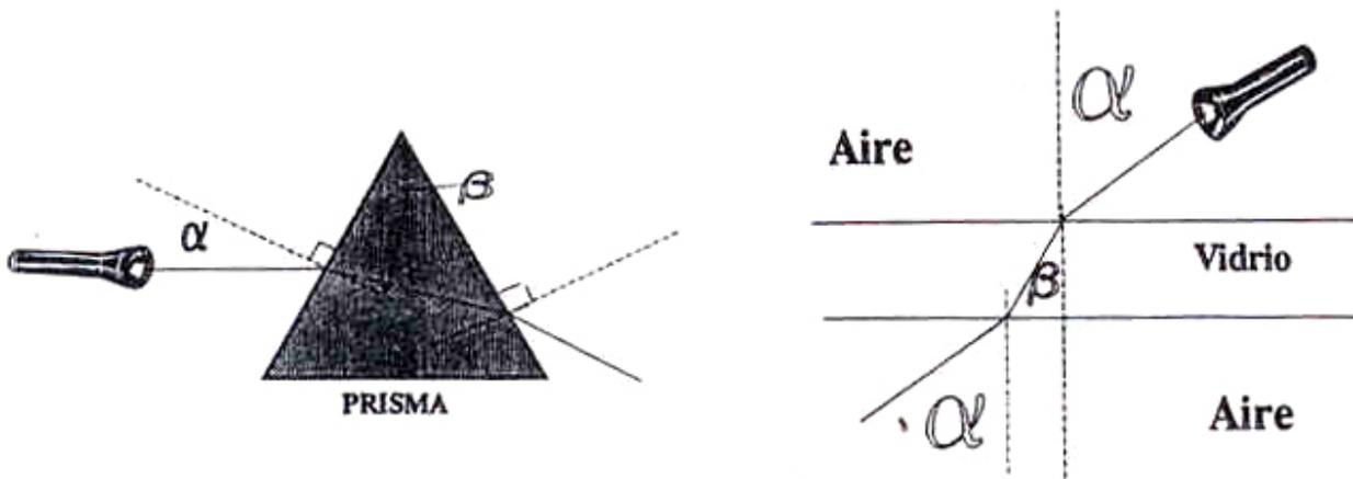
Supongamos que un haz de luz incide sobre un vidrio de caras paralelas y de 2 cm de espesor, con un ángulo de incidencia  $\alpha = 40^\circ$ . Determine el espesor  $d$  del vidrio para el cual el rayo de luz emergente se encontrará paralelamente desplazado respecto al incidente. (Ver Figura).
