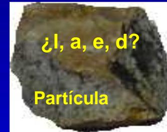
El tamaño de una partícula irregular es difícil o imposible de determinar en forma exacta. Los términos LONGITUD, ANCHO, ESPESOR y DIÁMETRO; tienen poco significado, ya que se presentan muchos valores distintos.
