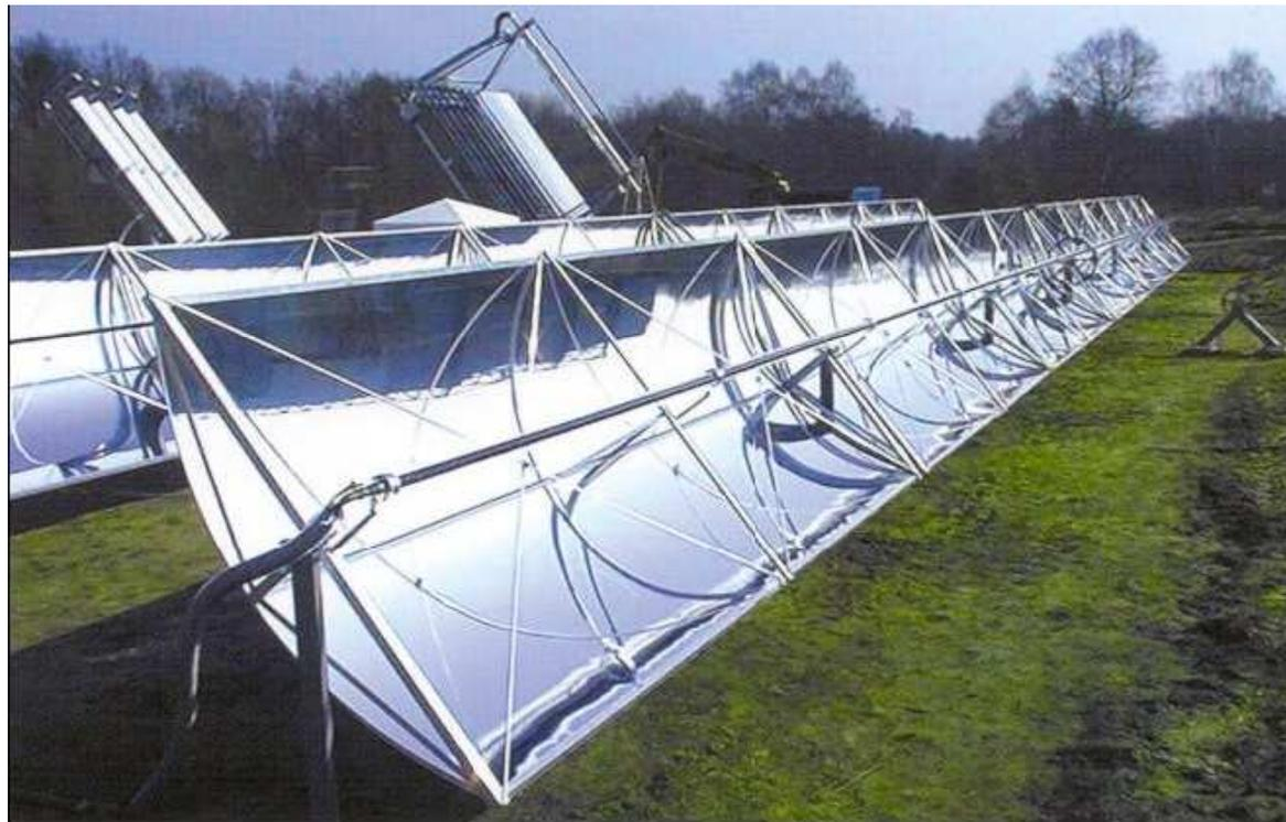
Colectores cilindro parabólicos para generar calor industrial
