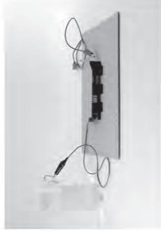
➔ Toquen el alambre que está puesto en el vaso con la pinza del extremo libre del cable conectado al LED. Comprueben si el LED enciende.
