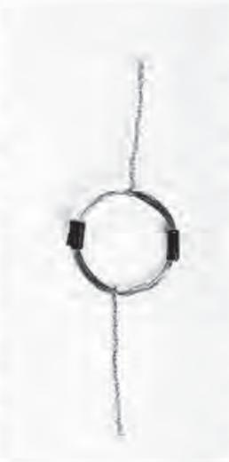
5. El alambre de bobina está recubierto por un esmalte, el que debe ser quitado de los extremos para realizar la conexión eléctrica. Pídanle a su profesor que lo haga.
