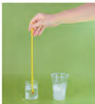
Estas imágenes muestran el montaje del experimento. Recuerda que al medir la temperatura con el termómetro, este no debe tocar las paredes del vaso precipitado.
