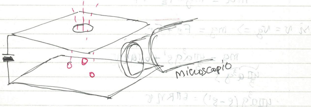
gotas de aceite cargadas eléctricamente. Cola entre 2 planchas metálicas sobre las cuales se aplica un voltaje conocido.
