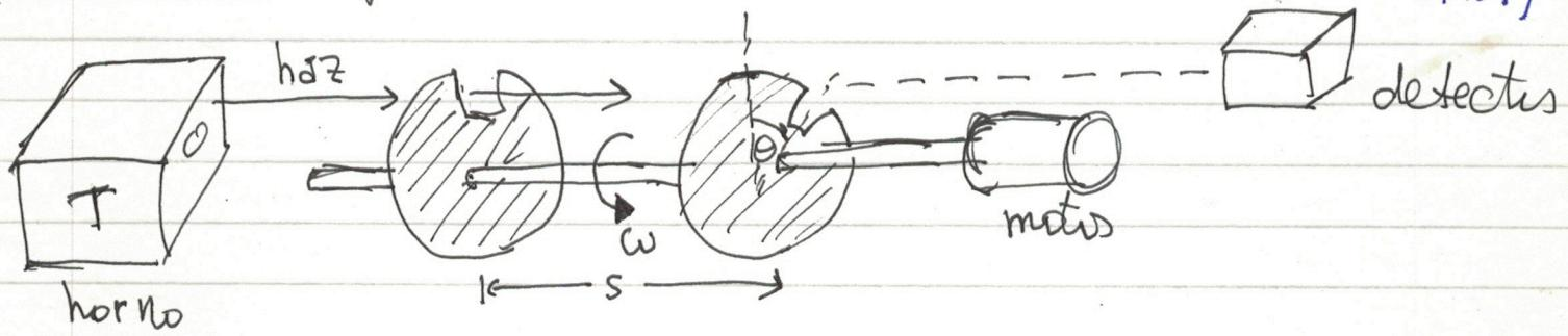
para  $\omega$  dado, sólo pasan al detector aquellas moléculas que cumplen:  $t = \frac{s}{v} = \frac{\theta}{\omega}$
