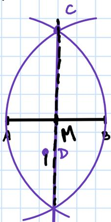
Para construirla debemos primeramente encontrar el punto medio  $M$  de  $\overline{AB}$ , trazamos 2 circunferencias de radio  $\overline{AB}$  una con centro en  $A$  y otra con centro en  $B$ , obteniendo los puntos  $C$  y  $D$
