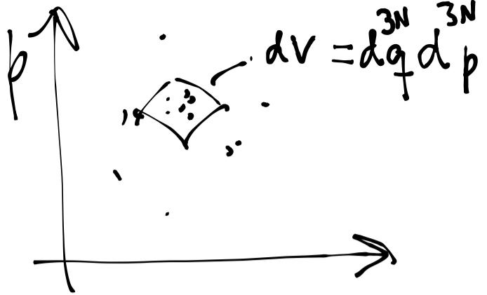
$N(q, p) \frac{dq^3N dp^3N}{\rho(q, p) dV}$  } Nro. de puntos representativos del sistema en vol. dV
