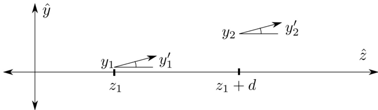
$$\begin{pmatrix} y_2 \\ y'_2 \end{pmatrix} = \begin{pmatrix} 1 & d \\ 0 & 1 \end{pmatrix} \begin{pmatrix} y_1 \\ y'_1 \end{pmatrix} \quad (4)$$
