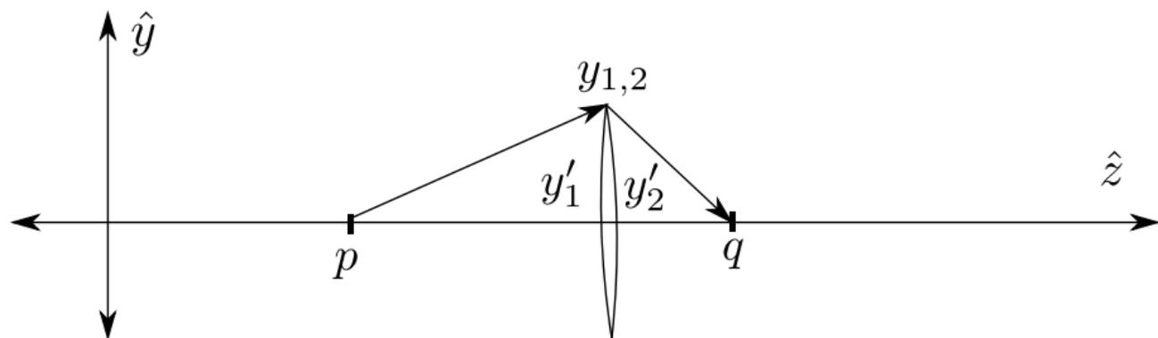
$$\begin{pmatrix} y_1 \\ y'_2 \end{pmatrix} = \begin{pmatrix} A & B \\ C & D \end{pmatrix} \begin{pmatrix} y_1 \\ y'_1 \end{pmatrix} \quad (5)$$
