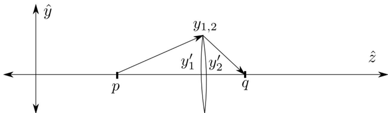
$$\begin{pmatrix} y_2 \\ y'_2 \end{pmatrix} = \begin{pmatrix} 1 & 0 \\ -\frac{1}{f} & 1 \end{pmatrix} \begin{pmatrix} y_1 \\ y'_1 \end{pmatrix} \quad (8)$$
