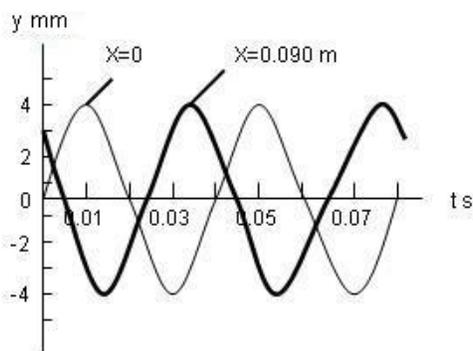
Figura 1: Desplazamiento de una cuerda para dos posiciones  $x$  distintas.
