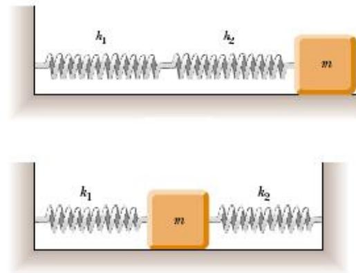
Figura 4: (a)(arriba) Un bloque conectado a dos resortes en serie. (b) (abajo) Un bloque entre dos resortes fijos.
