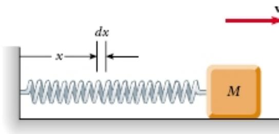
Figura 2: Sistema oscilatorio con movimiento armónico simple.
