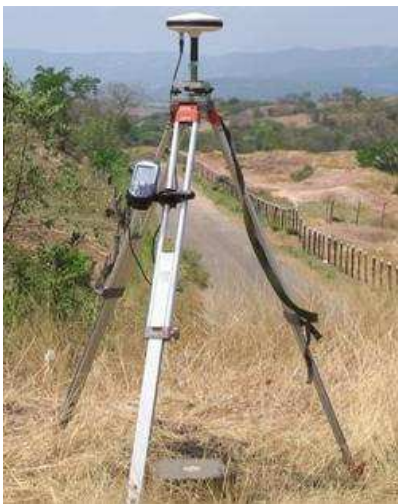
Figura 3.10.- Corrección diferencial de las medidas realizadas en terreno.
