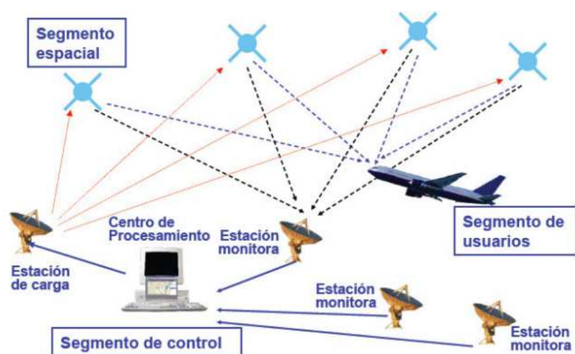
Figura 3.4.- Funcionamiento del GNSS basados en los tres segmentos que lo definen.
