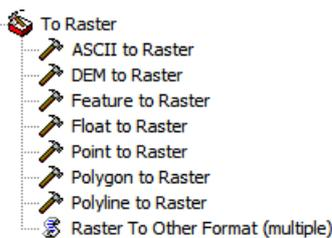
Todos los GIS traen herramientas para la conversión raster-vector o viceversa. En ArcMap hay varias formas convertir datos hacia el formato raster, por ejemplo el convertir un archivo de puntos en un raster. Para reliaizar esta tarea se utilizarán las herramientas de geoprocresamiento para la conversión. Las herramientas de conversión vector a raster se encuentran en **ArcTooBox** en **Conversion Tools->To Raster**, cuyas herramientas se muestran en la figura adjunta.
