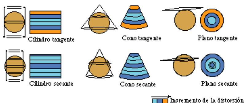
Figura 1.21.- Ejemplos de tipos de proyecciones cartográficas y sus distorsiones aproximadas.
