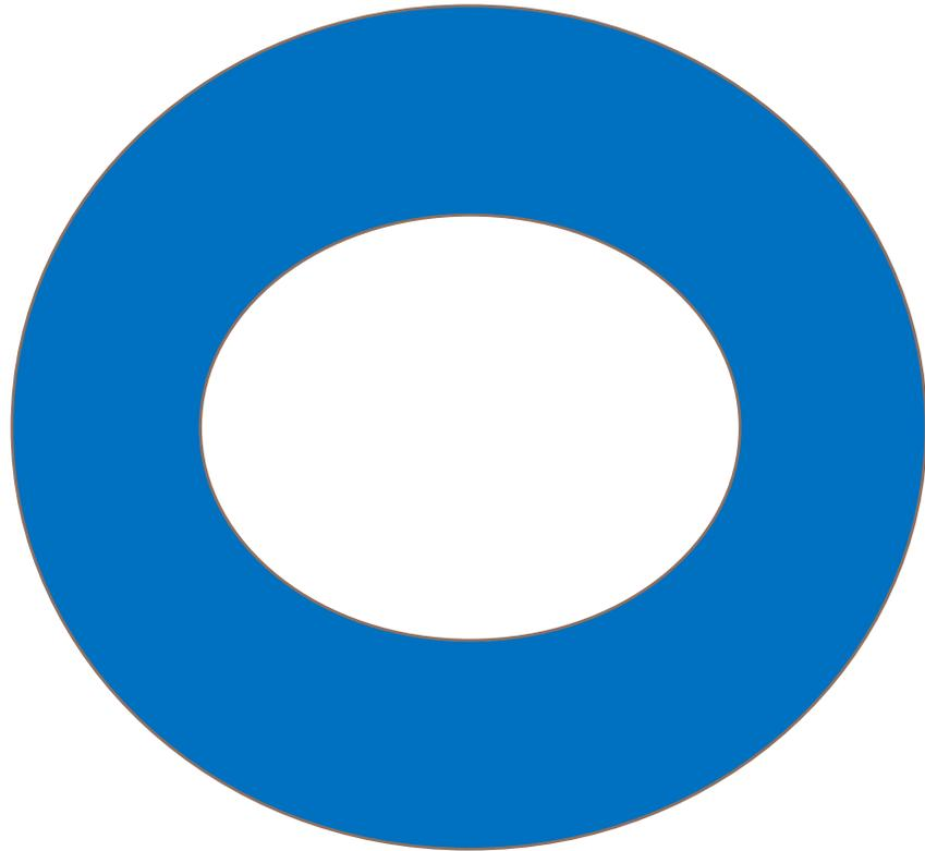
Considere el disco de la figura el cual representa la sección transversal de un cilindro, en el que el radio externo es  $b$  y el radio interno es  $a$ . Si por el disco fluye una corriente  $I$  saliendo de la pantalla, determine el campo magnético que se genera.
